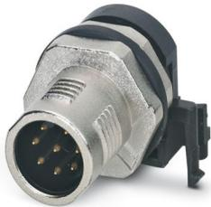
Gerätesteckverbinder Hinterwand, 8-polig, Stift, gewinkelt, M12-SPEEDCON, A-Kodierung, THR- und Wellenlöten, Artikel ist bleifrei nach RoHS II ohne Ausnahme 6c (Pb < 0,1 %)
