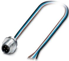
Gerätesteckverbinder Vorderwand, 3-polig, Stift, gerade, M12-Standard, A-Kodierung, auf freies Leitungsende, Einzellitzen, Kabellänge: 0,5 m, 0,34 mm<sup>2</sup>, TPE-Litze, vergossen, Artikel ist bleifrei nach RoHS II ohne Ausnahme 6c (Pb < 0,1 %)
