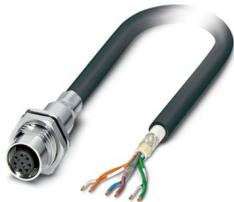
Gerätesteckverbinder Hinterwand, 6-polig, SANTOPRENE halogenfrei, schwarz RAL 9005, geschirmt, Buchse, gerade, M12, A-Kodierung, auf freies Leitungsende, Kabelanschluss, Kabellänge: 0,5 m, 0,25 mm<sup>2</sup>, Artikel ist bleifrei nach RoHS II ohne Ausnahme 6c (Pb < 0,1 %)
