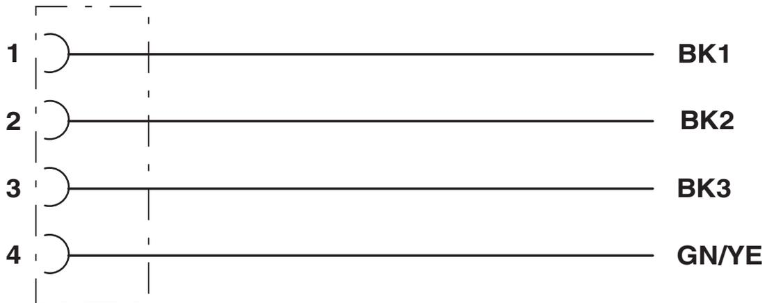
Kontaktbelegung der M12-Buchse
