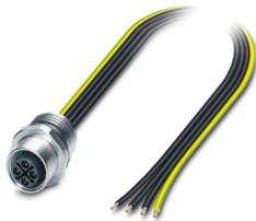
Gerätesteckverbinder Vorderwand, Leistung, 4-polig, Buchse, gerade, M12-Standard, S-Kodierung, auf freies Leitungsende, Einzellitzen, Kabellänge: 2,5 m, 1,31 mm<sup>2</sup>, UL/cUL Schaltlitze, vergossen, Artikel ist bleifrei nach RoHS II ohne Ausnahme 6c (Pb < 0,1 %)
