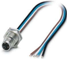
Gerätesteckverbinder Hinterwand, Leistung, 4-polig, Stift, gerade, M12-Standard, L-Kodierung, auf freies Leitungsende, Einzellitzen, Kabellänge: 0,2 m, 2,50 mm<sup>2</sup>, PEX-Litze, vergossen, Artikel ist bleifrei nach RoHS II ohne Ausnahme 6c (Pb < 0,1 %)
