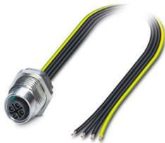
Gerätesteckverbinder Hinterwand, Leistung, 4-polig, Buchse, gerade, M12, S-Kodierung, auf freies Leitungsende, Einzellitzen, Kabellänge: 2 m, 1,31 mm<sup>2</sup>, UL/cUL Schaltlitze, vergossen, Artikel ist bleifrei nach RoHS II ohne Ausnahme 6c (Pb < 0,1 %)
