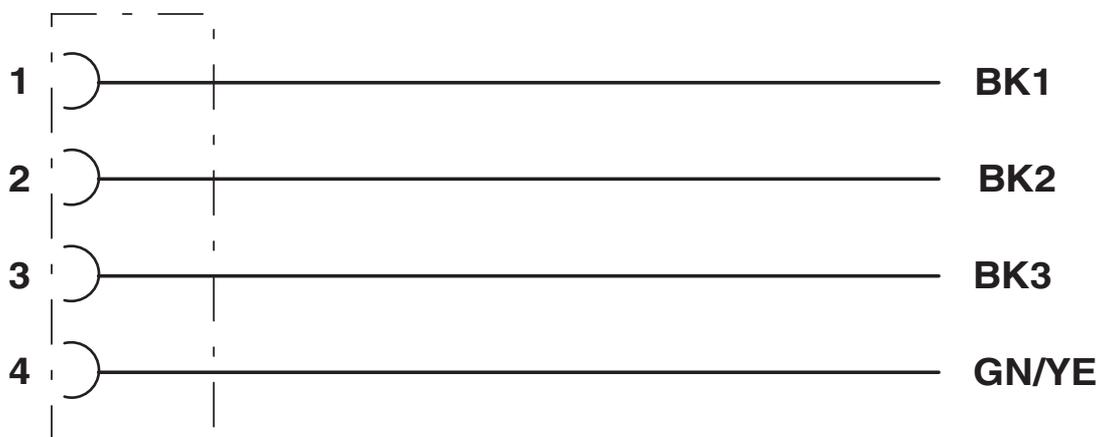
Kontaktbelegung der M12-Buchse
