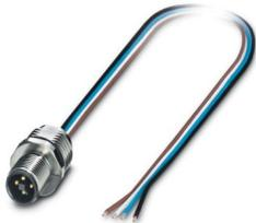
Gerätesteckverbinder Vorderwand, Leistung, 4-polig, Stift, gerade, M12-Standard, T-Kodierung, auf freies Leitungsende, Einzellitzen, Kabellänge: 0,5 m, 1,31 mm<sup>2</sup>, UL/cUL Schaltlitze, vergossen, Artikel ist bleifrei nach RoHS II ohne Ausnahme 6c (Pb < 0,1 %)
