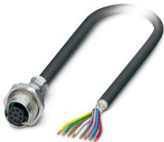
Gerätesteckverbinder Hinterwand, Universal, 8-polig, PUR halogenfrei, schwarzgrau RAL 7021, geschirmt, Buchse, gerade, M12-SPEEDCON, A-Kodierung, auf freies Leitungsende, Kabelanschluss, Kabellänge: 2 m, 0,25 mm<sup>2</sup>, PUR halogenfrei schwarz, Artikel ist bleifrei nach RoHS II ohne Ausnahme 6c (Pb < 0,1 %)
