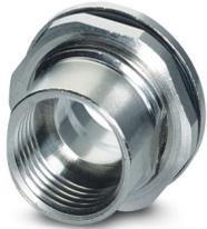
Gehäuseverschraubung, Buchse, M12-Schraubverriegelung, THR-Lötanschluss, Artikel ist bleifrei nach RoHS II ohne Ausnahme 6c (Pb < 0,1 %)
