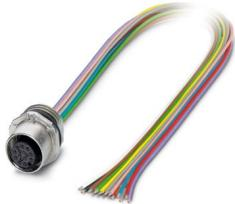
Gerätesteckverbinder Vorderwand, Universal, 12-polig, Buchse, gerade, M12-SPEEDCON, A-Kodierung, auf freies Leitungsende, Einzellitzen, Kabellänge: 3 m, 0,14 mm<sup>2</sup>, TPE-Litze, vergossen, Artikel ist bleifrei nach RoHS II ohne Ausnahme 6c (Pb < 0,1 %)
