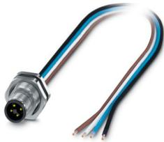
Gerätesteckverbinder Hinterwand, Leistung, 4-polig, Stift, gerade, M12-Standard, T-Kodierung, auf freies Leitungsende, Einzellitzen, Kabellänge: 0,5 m, 1,31 mm<sup>2</sup>, UL/cUL Schaltlitze, vergossen, Artikel ist bleifrei nach RoHS II ohne Ausnahme 6c (Pb < 0,1 %)
