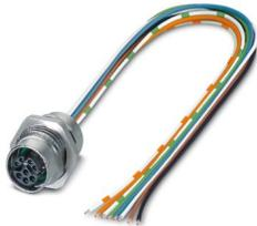
Gerätesteckverbinder Hinterwand, Ethernet Hybrid CAT5 (IEC 11801:2002) (100 MBit/s), 8-polig, Buchse, gerade, M12-SPEEDCON, Y-Kodierung, auf freies Leitungsende, Einzellitzen, Kabellänge: 0,5 m, 0,14 mm<sup>2</sup>, TPE-Litze, vergossen, Artikel ist bleifrei nach RoHS II ohne Ausnahme 6c (Pb < 0,1 %)
