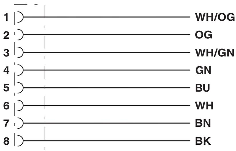
Kontaktbelegung des M12-Stecker
