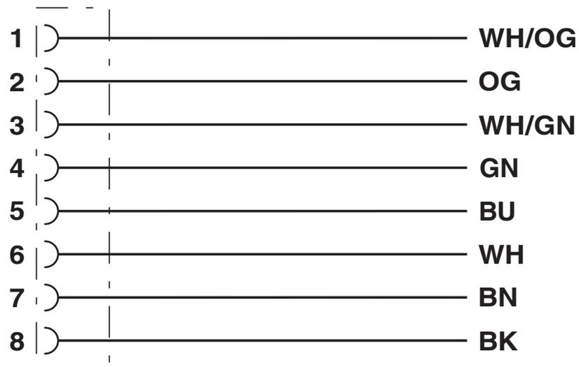
Kontaktbelegung des M12-Stecker
