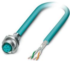
Gerätesteckverbinder Hinterwand, Ethernet CAT5 (100 MBit/s), Ethernet CAT5 (100 MBit/s), 4-polig, PUR, wasserblau RAL 5021, geschirmt, Buchse, gerade, M12-SPEEDCON, D-Kodierung, auf freies Leitungsende, Buskabel, Kabellänge: 2 m, 0,14 mm<sup>2</sup>, Ethernet flexibel CAT5, 2-paarig, Artikel ist bleifrei nach RoHS II ohne Ausnahme 6c (Pb < 0,1 %)
