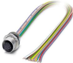
Gerätesteckverbinder Vorderwand, Universal, 17-polig, Buchse, gerade, M12-Standard, A-Kodierung, auf freies Leitungsende, Einzellitzen, Kabellänge: 0,5 m, 0,14 mm<sup>2</sup>, TPE-Litze, vergossen, Artikel ist bleifrei nach RoHS II ohne Ausnahme 6c (Pb < 0,1 %)
