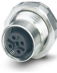
Gerätesteckverbinder Hinterwand, 4-polig, Buchse, gerade, M12-Standard, A-Kodierung, Wellenlöten, Artikel ist bleifrei nach RoHS II ohne Ausnahme 6c (Pb < 0,1 %)
