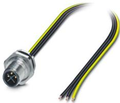
Gerätesteckverbinder Hinterwand, Leistung, 3-polig, Stift, gerade, M12, S-Kodierung, auf freies Leitungsende, Einzellitzen, Kabellänge: 1,5 m, 1,31 mm<sup>2</sup>, UL/cUL Schaltlitze, vergossen, Artikel ist bleifrei nach RoHS II ohne Ausnahme 6c (Pb < 0,1 %)
