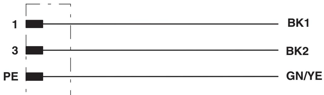
Kontaktbelegung des M12-Steckers
