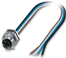
Gerätesteckverbinder Hinterwand, Leistung, 4-polig, Buchse, gerade, M12, T-Kodierung, auf freies Leitungsende, Einzellitzen, Kabellänge: 1,5 m, 1,31 mm<sup>2</sup>, UL/cUL Schaltlitze, vergossen, Artikel ist bleifrei nach RoHS II ohne Ausnahme 6c (Pb < 0,1 %)
