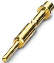
Crimpkontakt, Stift, gedreht, Kontaktdurchmesser: 1 mm, Anschlussquerschnitt: 0,5 mm<sup>2</sup> ... 1,5 mm<sup>2</sup>, Material Kontakt: CuZn, Artikel ist bleifrei nach RoHS II ohne Ausnahme 6c (Pb < 0,1 %)
