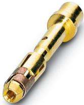
Crimpkontakt, Buchse, gedreht, Kontaktdurchmesser: 1 mm, Anschlussquerschnitt: 0,5 mm<sup>2</sup> ... 1,5 mm<sup>2</sup>, Material Kontakt: CuZn, Artikel ist bleifrei nach RoHS II ohne Ausnahme 6c (Pb < 0,1 %)
