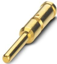
Crimpkontakt, Stift, gedreht, Kontaktdurchmesser: 2 mm, Anschlussquerschnitt: 0,25 mm<sup>2</sup> ... 2,5 mm<sup>2</sup>, Material Kontakt: CuZn, Artikel ist bleifrei nach RoHS II ohne Ausnahme 6c (Pb < 0,1 %)
