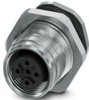
Gerätesteckverbinder Hinterwand, 5-polig, Buchse, gerade, M12-Push-Pull-Außenverriegelung, A-Kodierung, Wellenlöten, Artikel ist bleifrei nach RoHS II ohne Ausnahme 6c (Pb < 0,1 %)
