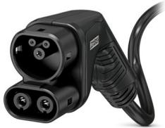
CHARX connect compact, CCS Typ 2, DC-Ladeleitung, 80 A dauerhaft, 1000 V DC, mit Fahrzeug-Ladestecker und offenem Leitungsende, Kabel: 4 m, schwarz, gerade, mit angeschlossenem PP-Kontakt, mit analoger Temperatursensorik, PHOENIX CONTACT-Logo, IEC 62196-3, zum Laden mit Gleichstrom (DC) von Elektrofahrzeugen (EV)
