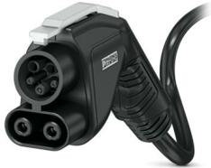
CHARX connect compact, CCS Typ 1, DC-Ladeleitung, 40 A dauerhaft, 1000 V DC, mit Fahrzeug-Ladestecker und offenem Leitungsende, Kabel: 4 m, schwarz, gerade, mit angeschlossenem CS-Kontakt, mit analoger Temperatursensorik, PHOENIX CONTACT-Logo, SAE J1772, IEC 62196-3, zum Laden mit Gleichstrom (DC) von Elektrofahrzeugen (EV)
