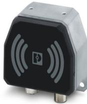
NearFi-Base, kontaktloser Echtzeit-Ethernet-Koppler, 100 MBit/s, Reichweite ≤40 mm, M12-Schraubanschluss, IP65, kombinierbar mit NEARFI D ETH R. Inkompatibel zu NEARFI 2000 (Neu)
