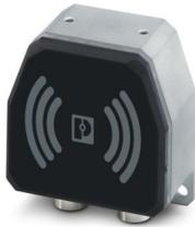
NearFi-Remote, kontaktloser Energie- und Echtzeit-Ethernet-Koppler, 50 W (US), 100 MBit/s, Reichweite ≤10 mm, M12-Schraubanschluss, IP65, kombinierbar mit NEARFI PD 2A ETH B. Inkompatibel zu NEARFI 2200 (Neu)
