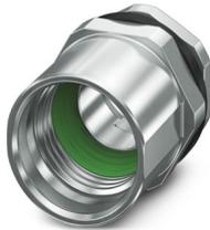
Gehäuseverschraubung, Buchse, M12-Push-Pull-Innenverriegelung, THR-Lötanschluss, Artikel ist bleifrei nach RoHS II ohne Ausnahme 6c (Pb < 0,1 %)
