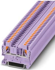
Durchgangsklemme, Nennspannung: 800 V, Nennstrom: 24 A, Anzahl der Anschlüsse: 2, Polzahl: 1, Anschlussart: Push-in-Anschluss, Bemessungsquerschnitt: 2,5 mm<sup>2</sup>, Querschnitt: 0,14 mm<sup>2</sup> - 4 mm<sup>2</sup>, Montageart: NS 35/7,5, NS 35/15, Farbe: violett
