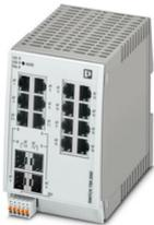
Managed TSN Switch 2000 Serie, 12 RJ45-Ports 10/100/1000 MBit/s, 2 SFP-Ports 100/1000 MBit/s, 2 Combo-Ports, Schutzart: IP20, Umgebungstemperatur (Betrieb): -40 °C ... 60 °C, Versorgungsspannungsbereich: 12 V DC ... 57 V DC, PROFINET Conformance-Class B, Entwicklungsprozess zertifiziert nach IEC 62443-4-1, Kompatibel zu IEC 62443-4-2
