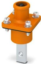
Steckverbinder, Artikelfamilie: BPC, Farbe: orange, Polzahl: 1, Aderquerschnitt min.: 16 mm<sup>2</sup>, Aderquerschnitt max.: 25 mm<sup>2</sup>, Bemessungsspannung: 1500, Bemessungsstrom: 120 A, Anschlussart: Schraubanschluss
