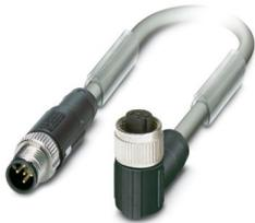
Bussystem-Kabel, CANopen®, DeviceNet™, 5-polig, PUR halogenfrei, silbergrau RAL 7001, geschirmt, Stecker gerade M12 SPEEDCON, Kodierung: A, auf Buchse gewinkelt M12 SPEEDCON, Kodierung: A, Kabellänge: 3 m, Steckverbinder ungeschirmt
