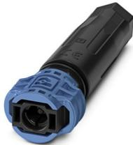
Steckverbinder, Artikelfamilie: BPP, Farbe: blau/schwarz, Polzahl: 1, Aderquerschnitt min.: 2,5 mm<sup>2</sup>, Aderquerschnitt max.: 6 mm<sup>2</sup>, Bemessungsspannung: 1500 V DC, Bemessungsstrom: 35 A, Anschlussart: Federkraft, Kabeldurchmesser min.: 5 mm, Kabeldurchmesser max.: 8 mm
