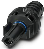
Gerätesteckverbinder Vorderwand, Artikelfamilie: BPP, Farbe: blau/schwarz, Polzahl: 1, Aderquerschnitt min.: 2,5 mm<sup>2</sup>, Aderquerschnitt max.: 6 mm<sup>2</sup>, Bemessungsspannung: 1500 V DC, Bemessungsstrom: 38 A, Anschlussart: Crimp, Kabeldurchmesser max.: 5,8 mm
