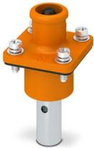
Steckverbinder, Artikelfamilie: BPC, Farbe: orange, Polzahl: 1, Aderquerschnitt min.: 16 mm<sup>2</sup>, Aderquerschnitt max.: 25 mm<sup>2</sup>, Bemessungsspannung: 1500, Bemessungsstrom: 120 A, Anschlussart: Crimp
