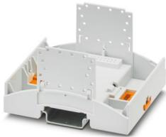
Tragschienengehäuse für den Einsatz in Installationsverteilern nach DIN 43880, Gehäuseunterteil mit Fußriegel, Breite: 71,6 mm, Höhe: 89,7 mm, Tiefe: 48,9 mm, Farbe: lichtgrau (ähnlich RAL 7035), Querverbindung: Tragschienen-Busverbinder (optional), Polzahl Querverbinder: 16
