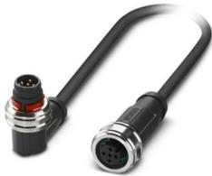
Sensor-/Aktor-Kabel, 5-polig, PUR halogenfrei, schwarzgrau RAL 7021, Stecker gewinkelt M12 Push-Pull, Kodierung: A, auf Buchse gerade M12 Push-Pull, Kodierung: A, Kabellänge: 1,5 m
