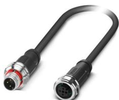
Sensor-/Aktor-Kabel, 3-polig, PUR halogenfrei, schwarzgrau RAL 7021, geschirmt (Advanced Shielding Technology), Stecker gerade M12 Push-Pull, Kodierung: A, auf Buchse gerade M12 Push-Pull, Kodierung: A, Kabellänge: 1,5 m
