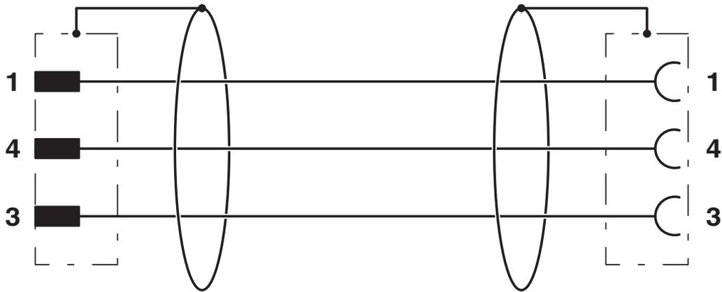
Kontaktbelegung des M12-Steckers und der M12-Buchse
