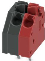
Leiterplattenklemme, Nennstrom: 8 A, Bemessungsspannung (III/2): 250 V, Nennquerschnitt: 1,5 mm<sup>2</sup>, Anzahl der Reihen: 1, Polzahl pro Reihe: 2, Artikelfamilie: PTSA 1,5, Rastermaß: 3,5 mm, Anschlussart: Push-in-Federanschluss, Montage: Wellenlöten, Anschlussrichtung Leiter/Platine: 45 °, Farbe: mehrfarbig, Pin-Layout: Lineares Front-Pinning, Pinlänge [P]: 3,5 mm, Anzahl der Lötpins pro Potenzial: 1, Verpackungsart: verpackt im Karton
