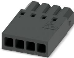
Leiterplattenstecker, Nennquerschnitt: 0,75 mm<sup>2</sup>, Farbe: schwarz, Nennstrom: 6 A, Bemessungsspannung (III/2): 160 V, Kontaktart: Buchse, Anzahl der Reihen: 1, Polzahl: 4, Artikelfamilie: PTCM 0,5/...-P, Rastermaß: 2,5 mm, Anschlussart: Crimpanschluss, Anschlussrichtung Leiter/Platine: 0 °, Stecksystem: COMBICON PTSM, Verriegelung: ohne, Befestigungsart: ohne, Verpackungsart: verpackt im Karton
