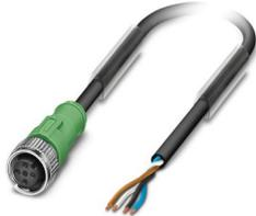
Sensor-/Aktor-Kabel, 4-polig, PUR halogenfrei, schwarzgrau RAL 7021, freies Leitungsende, auf Buchse gerade M12, Kodierung: A, Kabellänge: 25 m
