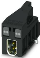
SPE-Leiterplatten-Steckverbinder, Bauform: IEC 63171-2, Schutzart: IP20, Polzahl: 2, 1 GBit/s, CAT B (ISO/IEC 63171), Material: Kunststoff, Anschlussart: THR-Lötanschluss, Kabelabgang: gerade, Single Pair Ethernet
