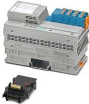
Axioline P, Analogeingabemodul, Passive analoge Eingänge: 8 (HART), 0 mA ... 20 mA, 4 mA ... 20 mA, Anschlussstechnik: 2-Leiter, Übertragungsgeschwindigkeit im Lokalbus: 100 MBit/s, HART-Funktionalität, eigensicher, Schutzart: IP20, inklusive Bussockelmodul und Axioline P-Steckern
