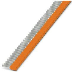
Band-Aderendhülsen, 0,5 mm<sup>2</sup>, Hüslenlänge 8 mm, mit Kunststoffkragen, nach DIN 46228-4, Sonderfarbe orange, ausgestattet mit Funktionsende zur sicheren und komfortablen Verarbeitung mit dem Crimphandy, 20 Streifen mit je 50 Hülsen pro Streifen.
