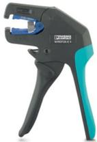
Abisolierwerkzeug, für Leitungen und Leiter (speziell auch für Gummi- und Silikon-Isolierungen) von 0,1 - 4 mm<sup>2</sup>, selbstjustierend, Abisolierlänge bis 18 mm, Schneidvermögen bis 10 mm<sup>2</sup> flexibel /1,5 mm<sup>2</sup> starr, Abisoliermesser austauschbar
