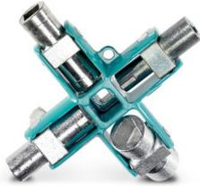
Schaltschrankschlüssel, aus Metall, für alle gängigen Schließungen: Doppelbart 3 - 5 mm, Vierkant 5 mm, 6 mm, 7 - 8 mm, 9 - 10 mm, Dreikant 7 mm, 8 - 9 mm, 10 - 11 mm, Sonder 6 mm
