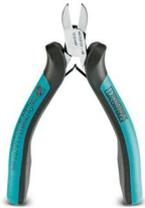
Elektronik-Seitenschneider, runder Kopf, ohne Fase, mit Öffnungsfeder, spiegelpoliert und geölt, 2-Komponenten Griff, Schneidkapazität: weich 0,2 - 2,0 mm; mittelhart 1,2 mm; hart 0,5 mm Durchmesser
