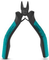
ESD Elektronik-Seitenschneider, runder Kopf, ohne Fase, mit Öffnungsfeder, entspiegelt und phosphatiert, 2-Komponenten Griff, Schneidkapazität: weich 0,2 - 2,0 mm; mittelhart 1 mm Durchmesser
