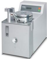
Abisolier- und Crimpautomat, Eingangsspannung 100 V ... 240 V, elektro-pneumatisch, für lose Aderendhülsen mit Isolierkragen, 4 mm<sup>2</sup>, 6 mm<sup>2</sup> und 10 mm<sup>2</sup>, ohne Umrüstsatz
