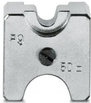
Gesenk (Unterteil), für CRIMPFOX-C120, für unisolierte Kabelschuhe (DIN 46234) 6 + 50 mm<sup>2</sup>, Indent-Crimp
