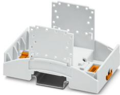
Tragschienengehäuse für den Einsatz in Installationsverteilern nach DIN 43880, Gehäuseunterteil mit Fußriegel, Breite: 53,6 mm, Höhe: 89,7 mm, Tiefe: 48,9 mm, Farbe: lichtgrau (ähnlich RAL 7035), Querverbindung: Tragschienen-Busverbinder (optional), Polzahl Querverbinder: 16
